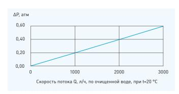
Характеристики производительности фильтрующих элементов высотой 250 мм
